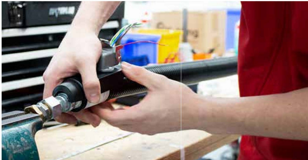
Fertigung eines Heizschlauchs mit integrierter Heizleitung.
